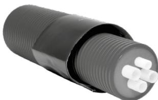
Le tube ondulé HD-PE peut être soit cimenté dans du béton, soit cimenté dans l'embrasure du mur. Environ 100 mm de tube ondulé doit ressortir afin qu'il puisse être étanchéisé avec le manchon rétractable Microflex. Pour de plus amples informations, consulter le paragraphe 2.3 des instructions de mise en œuvre.
